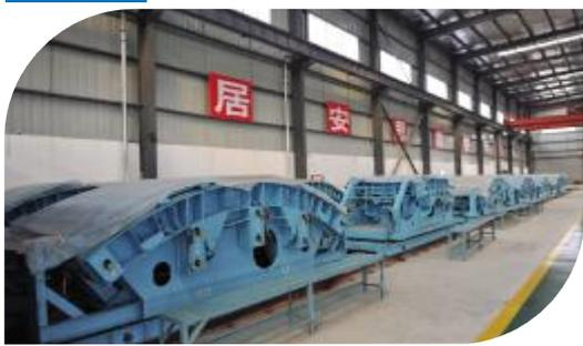
合肥地铁1号线所用管片由6片组成,分别为标准块A1、A2、A3,邻接块B1、B2和封顶块K。所用模具精度达到0.001毫米,使得生产出的管片能够完全达到设计要求,为地铁隧道的安全和质量奠定了坚实基础。
