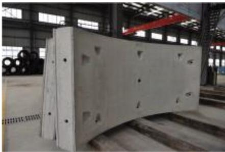
成品管片在出窑后将在车间内放置，直至管片的中心温度与室温相差不到15℃才可以运出生产车间下水养护。
