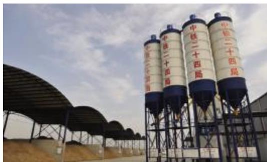
混凝土的质量也是管片生产过程中一个非常重要的因素。混凝土生产所需要的砂、石子、外加剂、粉煤灰等各种原材料,在经过试验检验合格后进入搅拌机搅拌。试验员在对每一盘混凝土试塌落度合格后进入下一阶段——浇注阶段。
