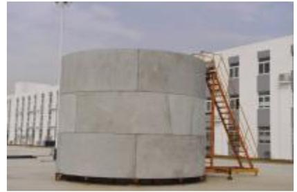
三环拼装是管片生产工艺中的反馈环节。这个环节可以反映出企业在管片生产过程所允许存在误差的浮动区间。拿着这些数据返回上游工序，对其工序进行改进，确保生产出的管片的质量完全可控。
