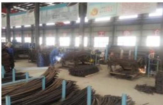
不同型号的钢筋按设计图纸被加工成形状不同的半成品后,在钢筋焊接区组装焊接成管片的钢筋骨架。该公司在生产过程中,对钢筋半成品的尺寸有严格要求,任何不符合设计要求的半成品都要重新加工,绝不允许进入下一道工序,确保管片拥有一个健康的“骨骼”。
